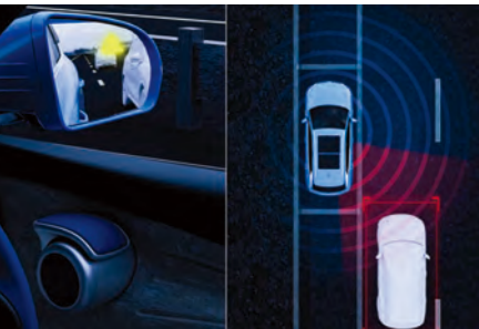
Door Open Warning (DOW)
